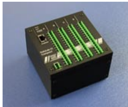
Obr 2: Jednotka průmyslových vstupů a výstupů DataLab s ethernetovým připojením do TCP/IP sítě
