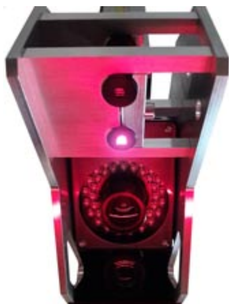
Obr 7: Pohyblivá hlava se dvěma kamerami DataCam a dvěma laserovými projektory čar
