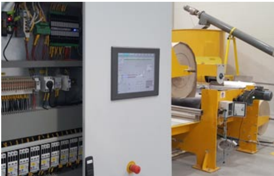
Obr 6: Efektivní automatizace výrobní linky se systémem Control Web - počítač s grafickým rozhraním pro obsluhu a v rozvaděči jednotka DataLab pro řízení stroje připojená přes Ethernet
