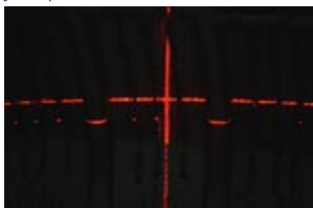
Obr 8: Laserové čáry, promítnuté na měřenou strukturu
